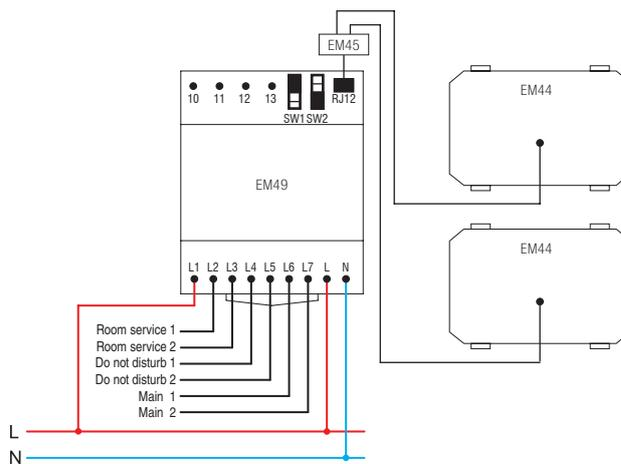
cablu de conectare RJ12 între EM44 și EM49 / connection cable RJ12 between EM44 and EM49
