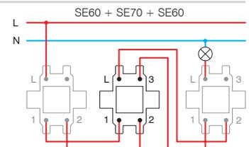
ÎNTRERUPĂTOR MONOPOLAR 10AX 250V~
