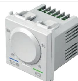
Termostatul este destinat reglării temperaturii în încăperi. Un termostat permite două moduri de funcționare – încălzire și răcire. Are funcții de siguranță instalate pentru protecție împotriva înghețului (mod încălzire) și protecție împotriva supraîncălzirii (mod răcire) Funcționarea se semnalizează cu ajutorul semnalizării LED. Configurarea termostatului este realizată cu ajutorul unui buton rotativ pentru setarea temperaturii și cu alte butoane tactile capacitive.
