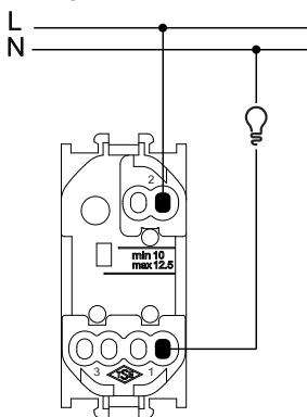
Întrerupător simplu (cu sau fără lampă de localizare)
